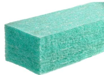
Le materie prime sono costituite da fibre di poliestere e fibre di co-poliestere termoleganti, provenienti in gran parte dal riciclo delle bottiglie di plastica ottenute dalla raccolta urbana differenziata.
